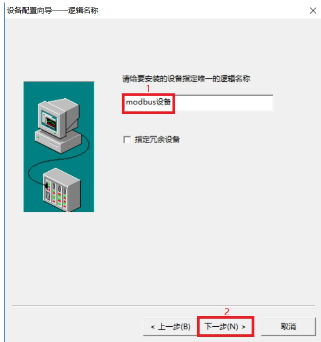
输入麦格米特 MC 系列 PLC 数据采集网关的地址，格式为【IP 地址：端口号 设备站号 / 延时时间】，默认为 192.168.1.188:502 1/50，点击【下一步】按钮；
