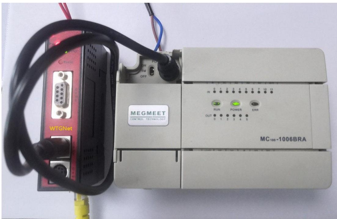
安装完成后, 我们通过网线将电脑和麦格米特 MC 系列 PLC 数据采集网关连接起来, 可以通过登录 WEB 网页或者参数设置工具两种方式对麦格米特 MC 系列 PLC 数据采集网关的参数进行设置。为了满足不同需求的用户, 麦格米特 MC 系列 PLC 数据采集网关的 WEB 网页界面支持中英文两种语言; 为了用户在实际应用中更加方便地管理现场设备, 麦格米特 MC 系列 PLC 数据采集网关开放了【设备名称】参数, 用户可以为麦格米特 MC 系列 PLC 数据采集网关连接的现场设备命名。
